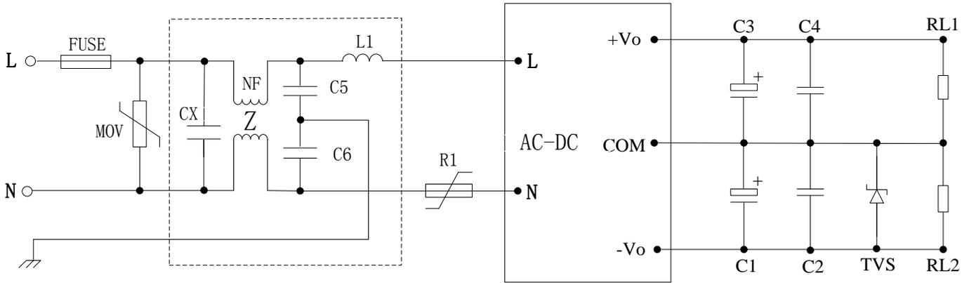
隔离双路输出EMC解决方案—推荐电路
