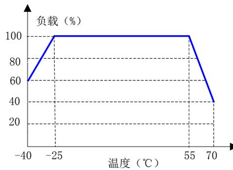
说明：需在输入电压降额的基础上进行温度降额。
